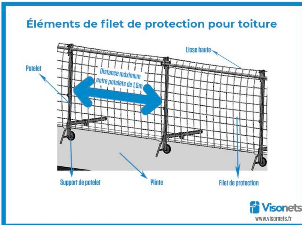
Dispositif d'immobilisation du support par serrage, chevillage, boulonnage, lestage.
